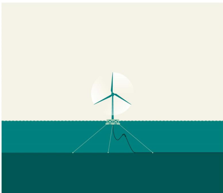
Figur 13. Flytande fundament anslutet med dynamisk kabel som kan hantera fundamentets rörelser.
